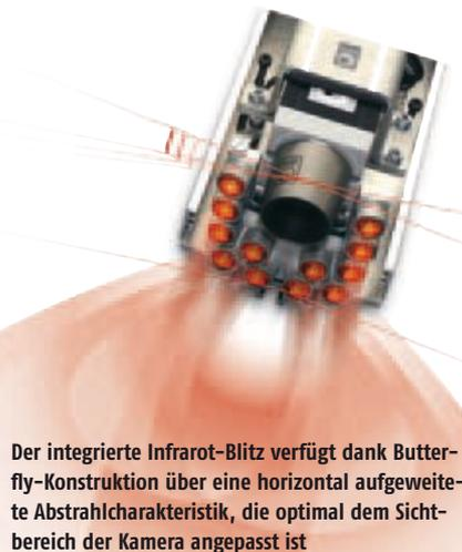
Der integrierte Infrarot-Blitz verfügt dank Butterfly-Konstruktion über eine horizontal aufgeweitete Abstrahlcharakteristik, die optimal dem Sichtbereich der Kamera angepasst ist
